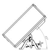
Cyclovator2は、エンクロージャーのフロントを上げる"プロジェクションアップ"にも、高層ビルの上に設置されたプロジェクターの"ダウン"にも対応可能です。
