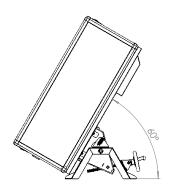
必要なチルト角が増加するに連れ、エンクロージャーはセンターから外れてマウントする事になります。これにより、過度に高いAフレームを使用せずに、急角度が可能となり、プロジェクターエンクロージャーの重心をCyclovatorの中心近くに出来ます。これは横風でイメージの動きを最小に抑える為には重要です。
