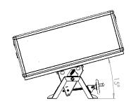
図は4種類の角度を表示していますが、0から60度の任意 の角度で設定・ロックが可能です。チルトが40度以上の場 合には、雨から内部フィルターを保護する吸気カウルを使 用して下さい。
