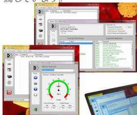
GetSetソフトウェアパッケージは、ネットワーク上の全てのRDM機器の検知、コンフィグ、モニターが出来ます。この例では、テンペストトルネードエンクロージャーが同じDMXライン上でモニターされ灯具が中にあります。
