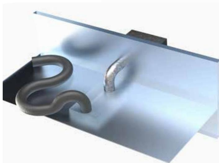
離れた場所から吸気を取り入れることが現実的でない場合は、「S」字型のフレキシブルなパッド付きホース (250mm ID) を使用して空気を吸い込み、吸気経路から漏れる騒音を消音します。
